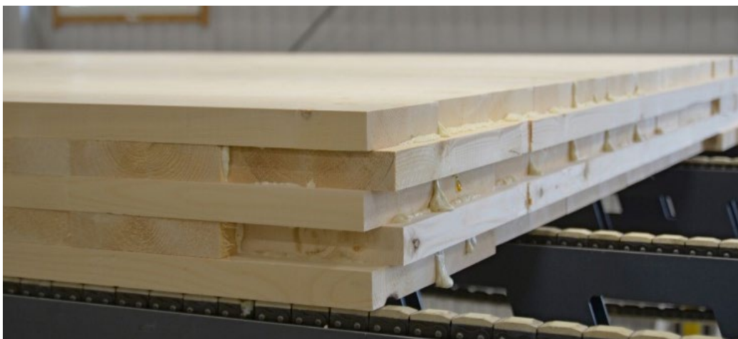
Panneaux massifs contrecollés ou CLT - crédit photographique : Holzkurier
